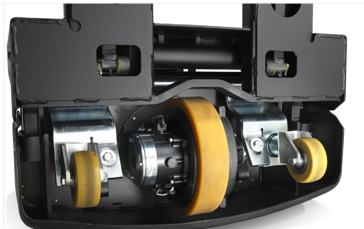
Het unieke Castorlink-systeem beschermt zwenkwielen op ongelijke ondergronden.
