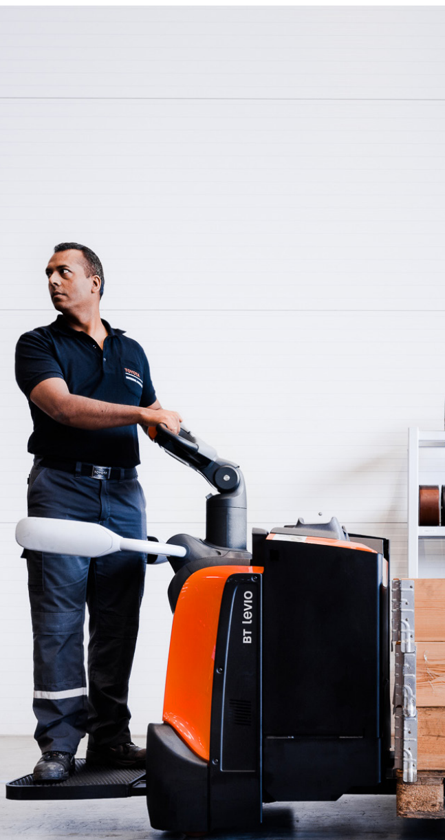
De hoogte van de stuurarm kan met een druk op de knop worden veresteld.
