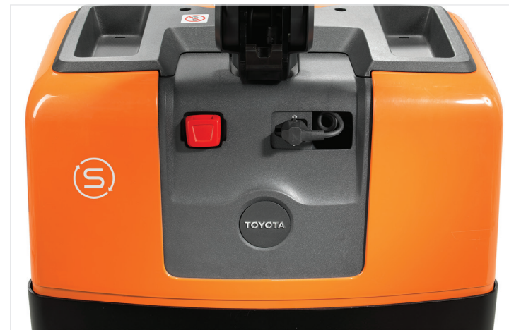
Het bedieningspaneel bevat een uittrekbaar netsnoer voor de ingebouwde batterijlader.
