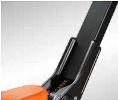
De robuuste, gelaste disselboom van de LHM230 verhoogt de productiviteit en verlaagt de levensduurkosten van het product
