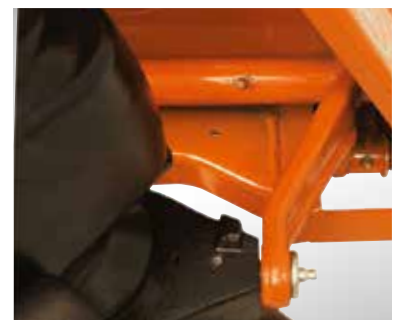
De LHM230 heeft 10/12 smeerpunten voor een langere levensduur, minder slijtage en effectief onderhoud
