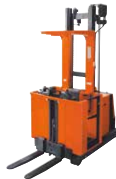
OME100M met extra hefmechanisme en OME100MW doorloop-uitvoering • Chassisbreedte 970 mm • Maximumcapaciteit 1000 kg • Verzamelhoogtes tot 6,3 m
