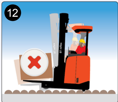
12 Schubmaststapler nur auf ebenen Böden einsetzen
