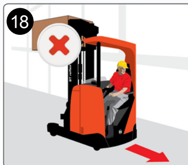
18 Nie mit angehobener Last fahren
