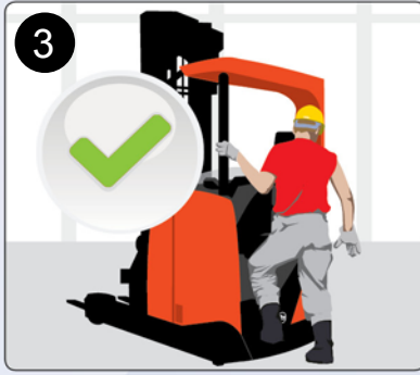
3 Benutzen Sie den Griff an der Vordersäule und die Stufe zum Ab- und Aufsteigen
