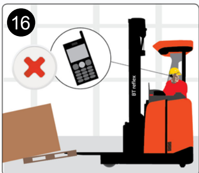
16 Achten Sie auf eine sichere Positionierung der Ware und lassen Sie sich nicht durch andere Dinge ablenken
