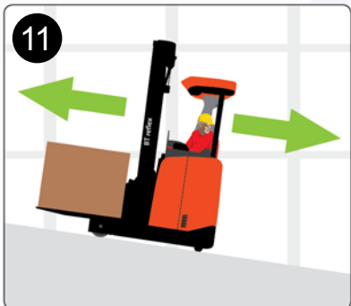
11 Im Gefälle Lasten immer bergseitig führen und auf Rampen nur geradeaus fahren
