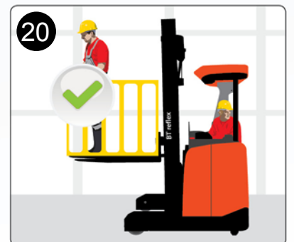
20 Für das Heben von Personen verwenden Sie das dafür vorgesehene und zugelassene Zubehör
