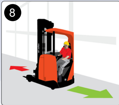
8 Vermeiden Sie bei längeren Wegstrecken das Fahren in Gabelrichtung
