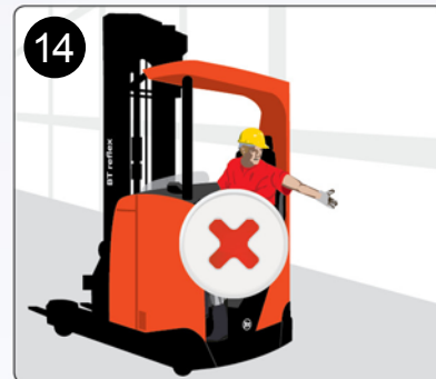
14 Halten Sie sich während der Fahrt immer im Innenbereich der Fahrerkabine auf. Bleiben Sie mit dem linken Fuß immer am Sicherheitsschalter
