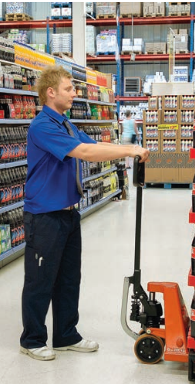
De stuurarm van de LHM230P brengt de wielen van de truck door middel van een hefboomeffect in beweging.
