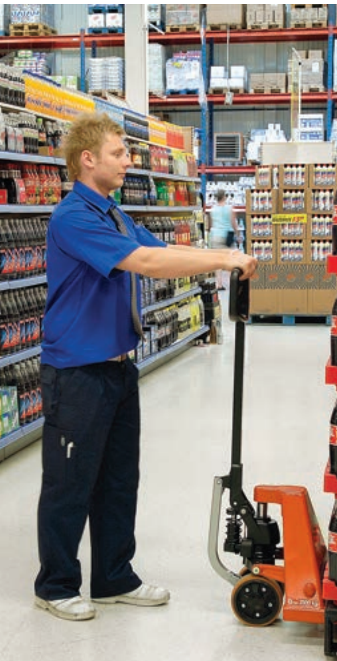
Le timon du LHM230P effectue un transfert de force vers les roues qui déclenche le mouvement du transpalette.
