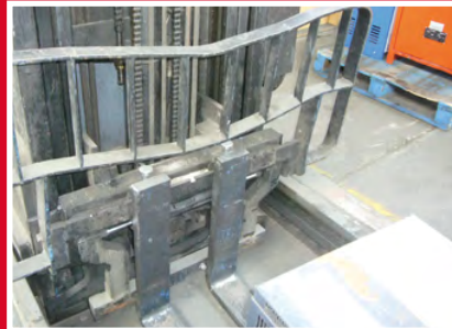
Schutzgitter stark verformt
