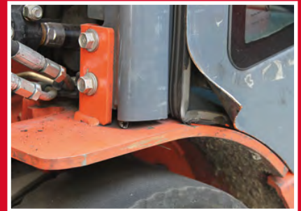
Teile, von denen Stücke abgebrochen sind oder die größere Verformungen aufweisen
