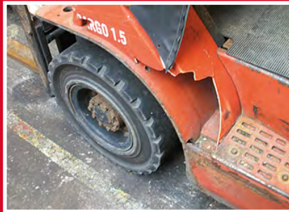
Teile, von denen Stücke abgebrochen sind oder die größere Verformungen aufweisen
