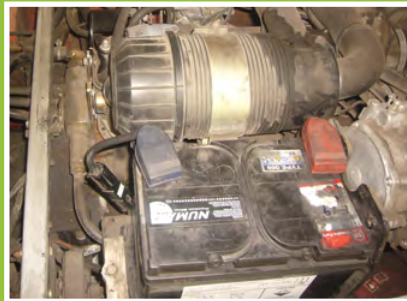
Starterbatterie und Luftfilter funktionstüchtig
