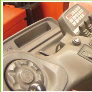
Armatur ohne Risse, Brüche oder fehlende Stücke
