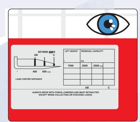
Kontrollige laadimisjoonist ning tõstke ja langetage kahvleid ilma koormata veendumaks, et need töötaksid õigesti.
