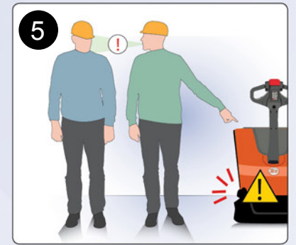
5 Schäden sofort melden
