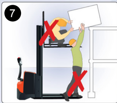
7 Verwenden Sie das Deichselgerät nicht als Aufstiegshilfe. Das Heben von Personen ist untersagt, verwenden Sie die dafür vorgesehenen Geräte
